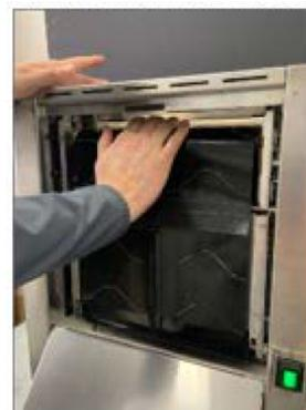
**6** Essuyer la bande pour éliminer tout débris provenant de l'installation. Fermer la porte et revenir en mode de fonctionnement normal.
