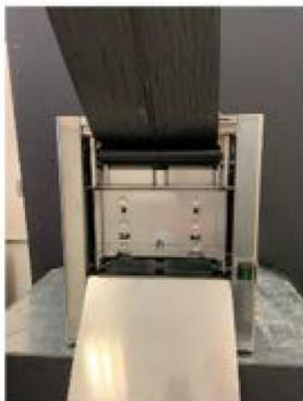
**2** Vérifier que le profil de guidage de la bande en silicone correspond aux rouleaux du convoyeur.
