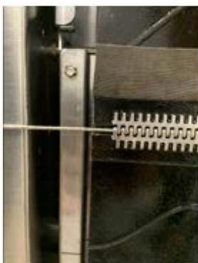
**4** Vérifier que la tige est entièrement insérée dans la fermeture à glissière.
