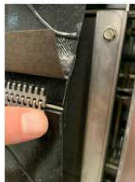
**5** Pousser le convoyeur vers le bas et vers l'avant. Les ressorts s'enclenchent et tirent la bande en silicone en place.
